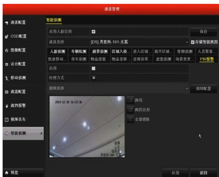
圖 4.228 智慧偵測 PIR 報警偵測配置介面
