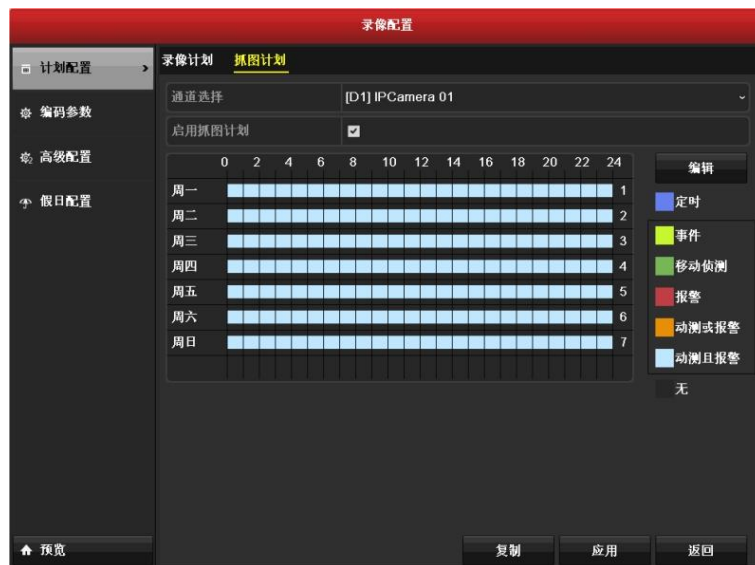
圖 4.121 動測且報警抓圖計畫完成介面
