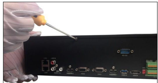
6、蓋好主機殼蓋板，並將蓋板用螺絲固定。
